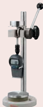
Měřicí stojánek: - Velikost stolu: \varnothing 90 mm - Max. výška vzorku: 90 mm
